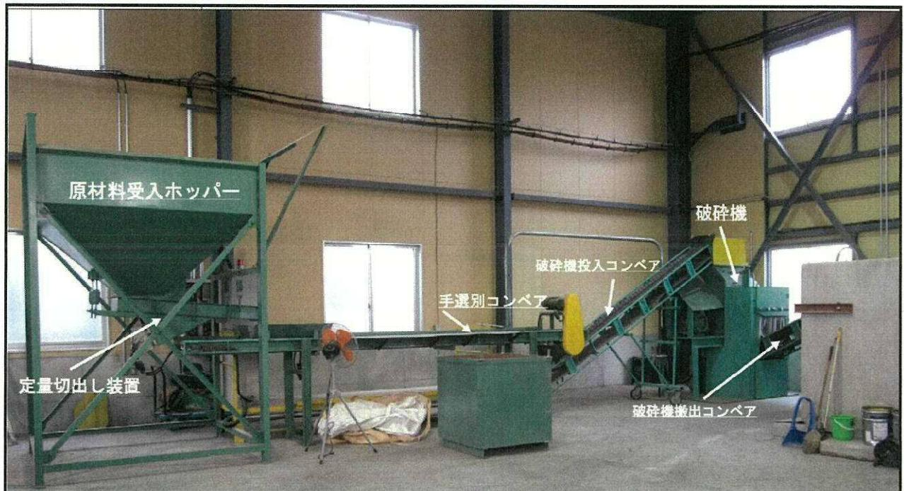
図-1 廃棄ビン類破碎施設処理工程
