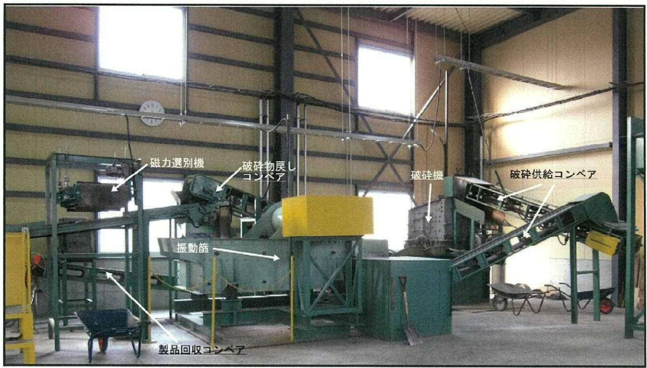
図-2 建材板ガラス等破碎施設処理工程
